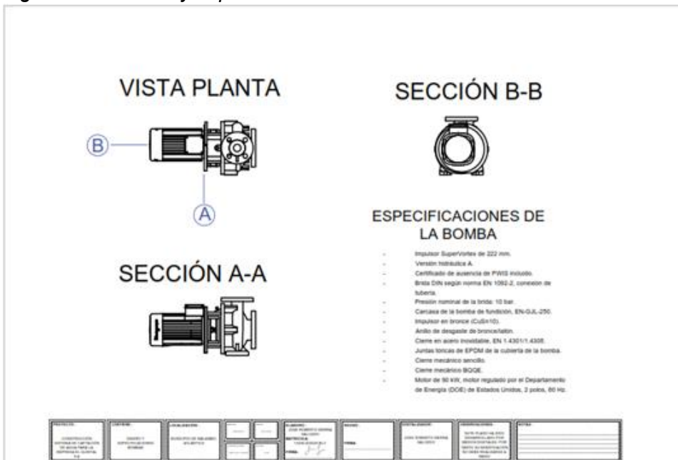
Figura 7.4 -Diseño y especificaciones de Bombas
