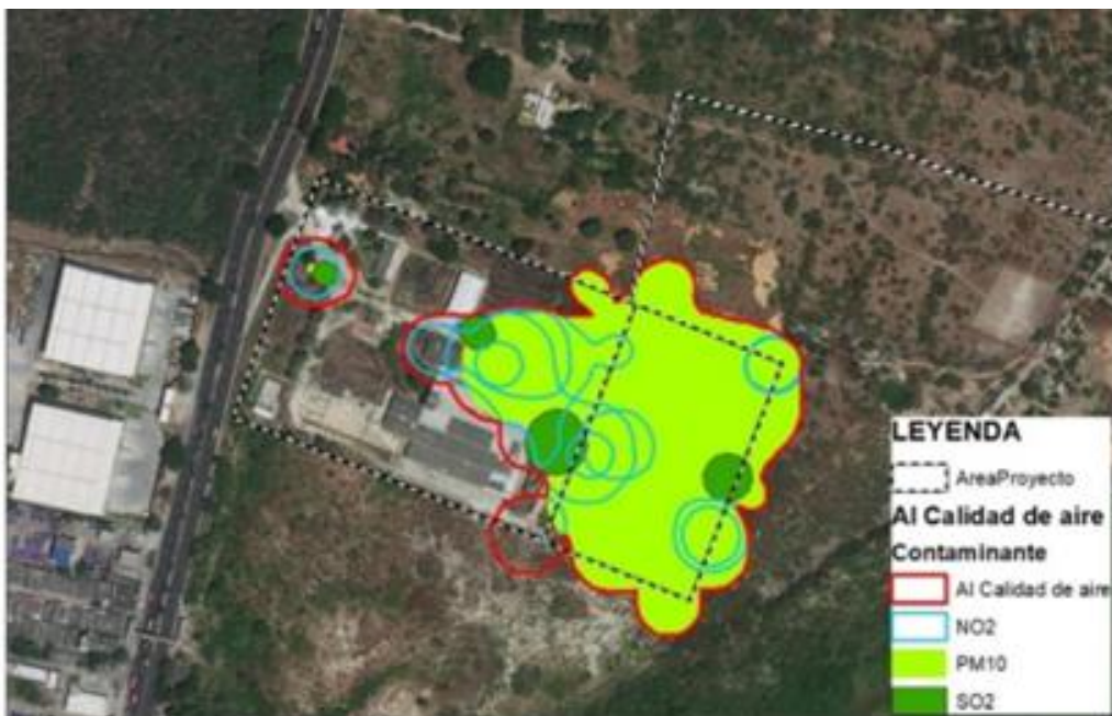
Figura 17: Área de influencia del componente atmosférico - Modelo de dispersión de calidad de aire
