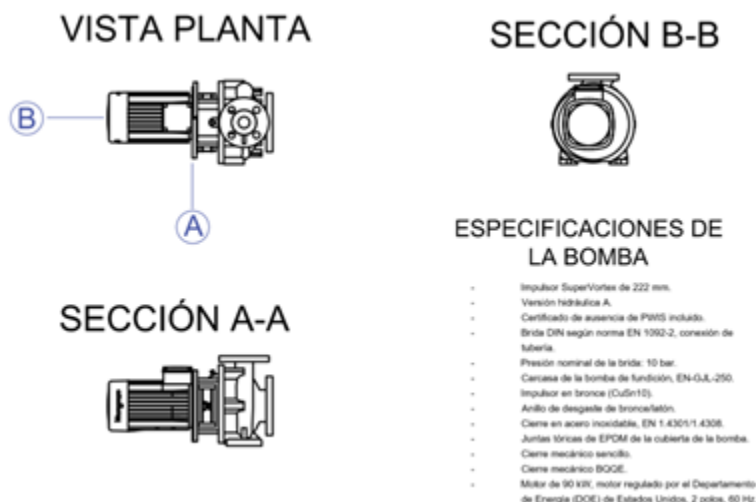
Figura 7–4 Vista bomba de impulsión.
